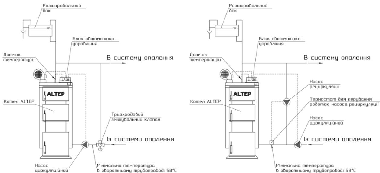
Рисунок 4 – Схеми підключення котла до системи опалення
