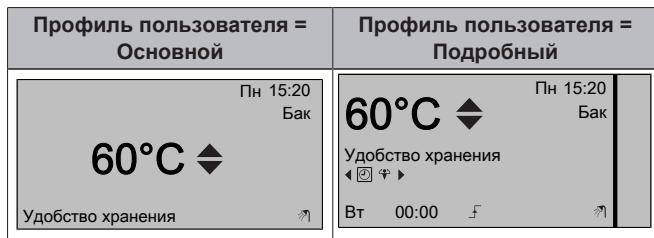
**Считывание и регулировка нужной температуры повторного нагрева (по расписанию и в режиме повторного нагрева)**
