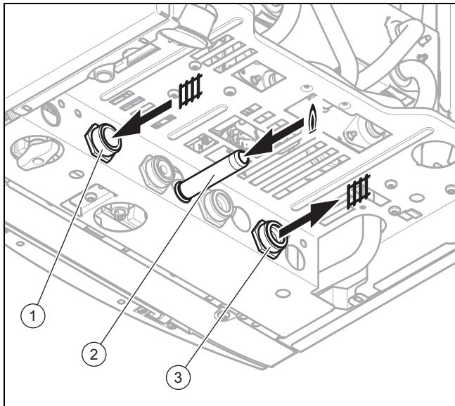
1. Встановіть без механічного напруження газопровід на приєднувальний патрубок газу (2), скориставшись запірним краном, що є в комплекті.
