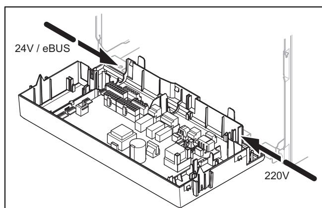
1. Проведіть проводи підключення вузлів, що підключаються, через кабельний ввід зліва через нижню сторону виробу.
