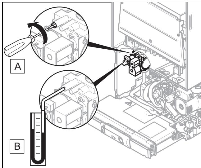
3. За допомогою викрутки послабте ущільнювальний гвинт на вимірювальному патрубку газової арматури.
